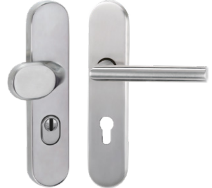
Titano Kombi SB 884 | 120 € Kombi-Schutzbeschlag ES1 (S2) gemäß DIN 18257, mit Kernziehschutz Edelstahl matt
