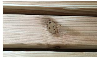
**Äste:** Die Äste und Maserung eines Holzes entsprechen der Charakteristik eines natürlich gewachsenen Rohstoffes. Jedes Stück ein Unikat! Äste unterliegen im Prinzip keinerlei
