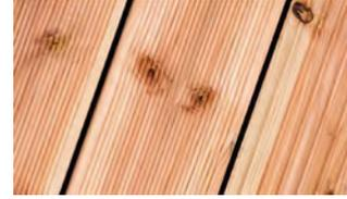
**Splintholz:** Als Splintholz wird das junge Holz direkt unter dem Kambium bezeichnet. In dem meist helleren Splintholz wird das Wasser von den Wurzeln zu den Blättern geleitet. Es hat dadurch eine geringere Festigkeit und ist nicht dauerhaft. Die Gebrauchsdauer von Splintholz kann nur durch einen chemischen Holzschutz oder eine Modifikation (TMT, Accoya®) gewährleistet werden. Ausgeprägtes Splintholz ist z.B. bei der Holzart Douglasie sehr gut zu erkennen.
