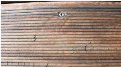
**Raue Stellen:** Trotz sorgfältiger Bearbeitung mit modernsten Maschinen lassen sich vereinzelt raue Stellen an der Holzoberfläche nicht vermeiden. Insbesondere bei Holzfasern, die gegen die Bearbeitungsrichtung verlaufen, z.B. um die Äste herum.
