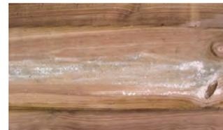
**Salzausblühungen:** Vor allem im ersten Jahr nach der Fertigstellung kann es vereinzelt zu Harzaustritten in dieser Form kommen. Durch die Kesseldruckimprägnierung wird das Harz grün-weiß eingefärbt. Dadurch entstehen kleine Flecken auf der Oberfläche. Die Sonne härtet diese Flecken, so dass diese abgebürstet oder abgewischt werden können. Mit der Zeit verwittern sie von allein und stellen keinen Grund zur Beanstandung dar.
