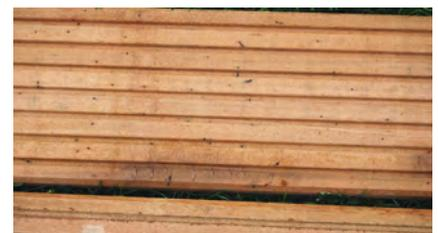
**Pinholes:** Hierbei handelt es sich um Fraßgänge kleiner Insekten, die keinerlei Einfluss auf die Dauerhaftigkeit oder Statik des Holzes haben. Die Insekten sind nicht mehr aktiv. Der Durchmesser der Pinholes beträgt ca. 1 bis 1,5 mm. Pinholes kommen z. B. bei Bangkirai und vereinzelt bei Massaranduba vor.
